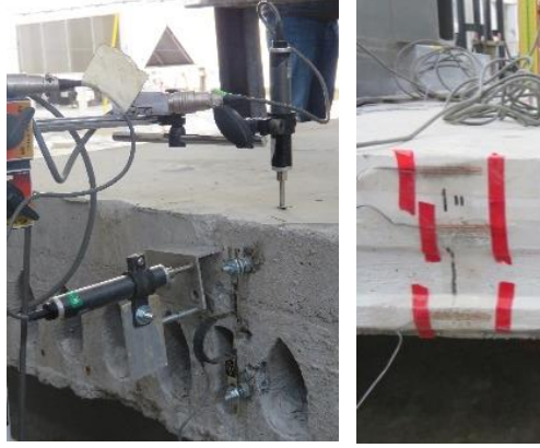
Şekil 5. ÖBD ve yapısal kaplama betonu arasında görelî kayma ve açılma hareketlerini kaydetmek üzere kullanılan ölçüm düzeni (sol resim) ve açıklık kesitine yapıştırılmış şekildeğiştirme ölçerler (sağ resim)
