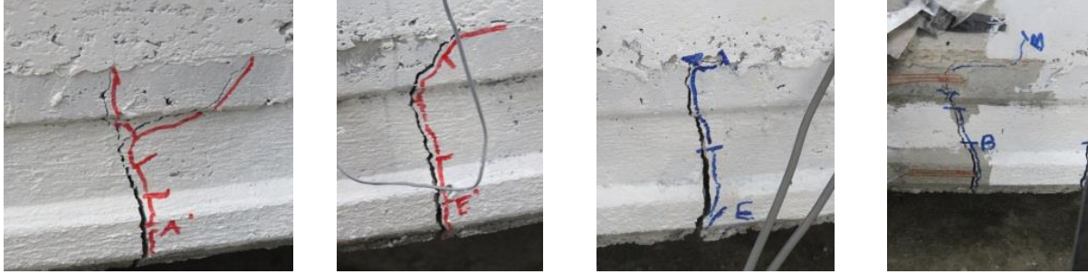
Şekil 17. Pürüzlendirilmiş numunelerde gerçekleşen bazı çatlakların ilerleme şekilleri
